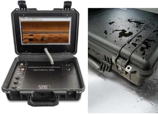
Влагозащищённый надводный блок управления АКВАТ 500 (далее –НБУ АКВАТ 500) предназначен для получения, регистрации, обработки и вывода информации от ТНПА АКВАТ 500 на экран
