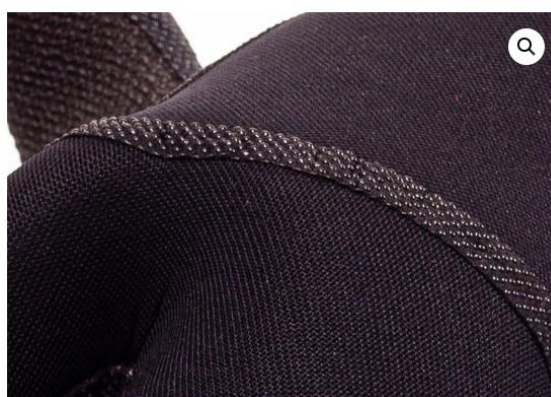
2 этап работы – швы проклеены лентой
