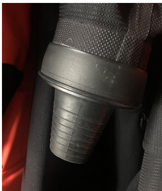
Установленные – вклеенные кольца с манжетами
