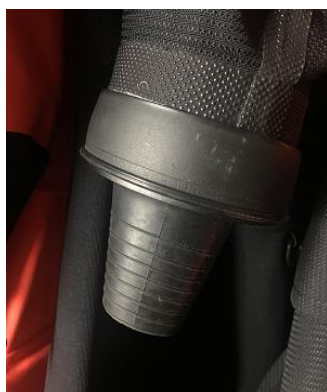
Установленные – вклеенные кольца с манжетами
